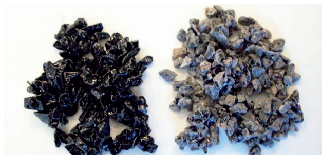
Bilderna visar skillnaden i restbitumenhalten efter tvättning med och utan aktiva vidhäftningsmineraler.
