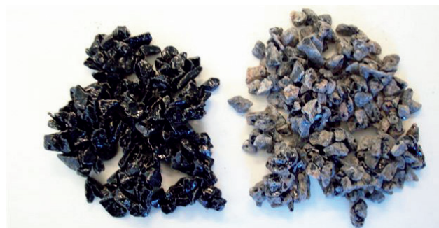
Bilden visar skillnaden mellan restbitumenhalten efter tvättning med och utan aktiva vidhäftningsmineraler.
